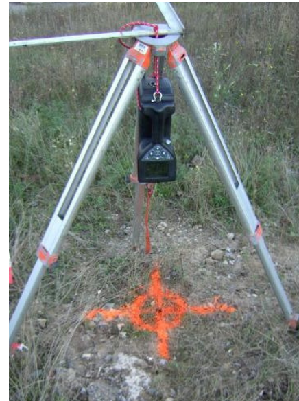
Abbildung 4-1: Gammaspektrometer mit Stativ zur Einstellung einer definierten Messhöhe von 1 m.
