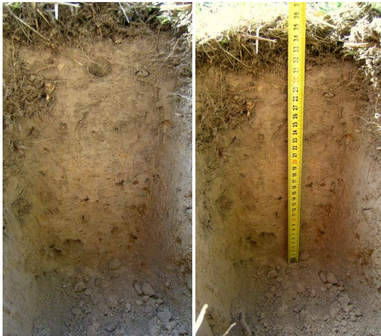
Abbildung 5-1: Bodenprofil am Standort Boden NO_2 bis 30 cm Tiefe aus dem in 5 cm Schichten Probenmaterial entnommen wurde.
