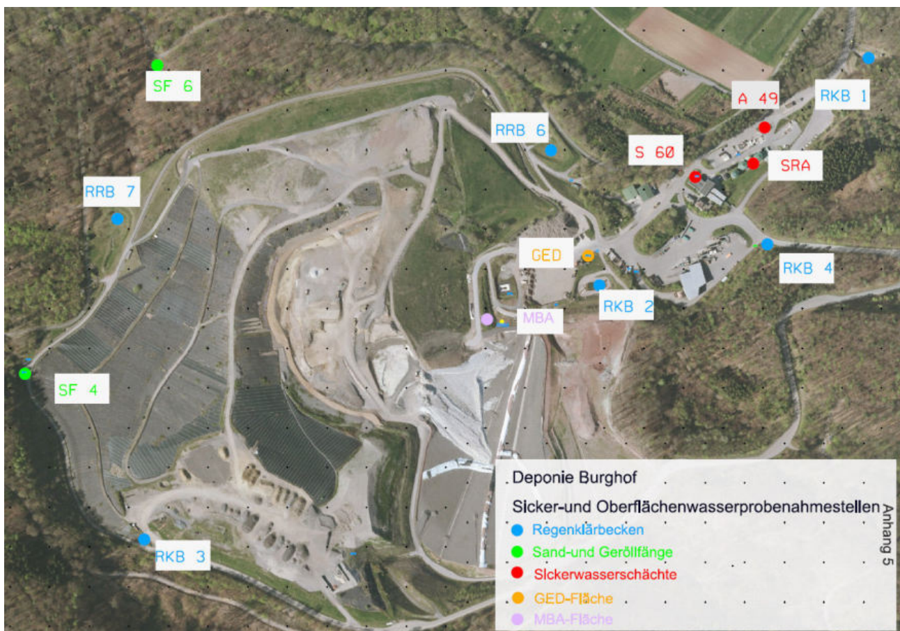
Abb. 7.8: Standorte der Regenklär- bzw. Regenrückhaltebecken
